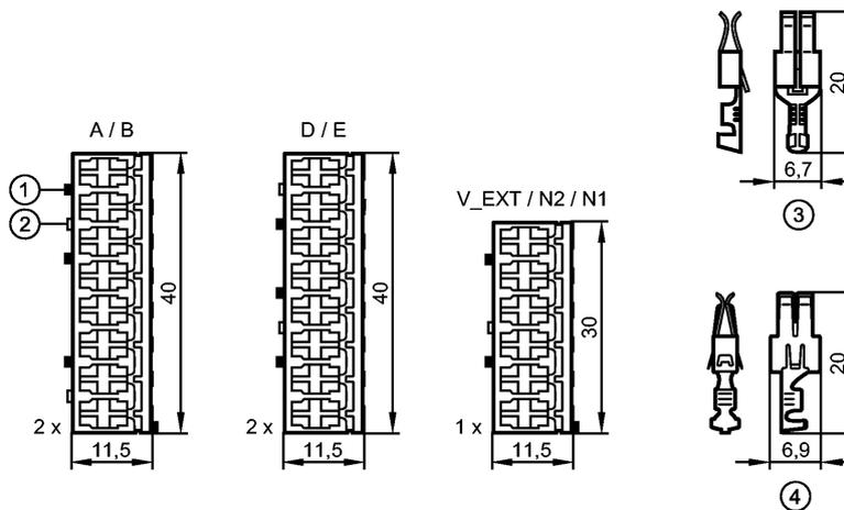
Abbildung zeigt Kontakt-Gehäuse mit geschlossenen Deckeln
