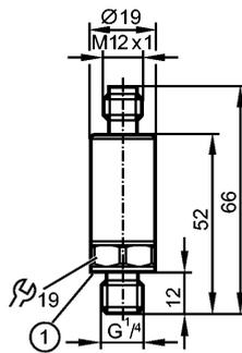
1: Dichtung Prozessanschluss FKM / DIN 3869
