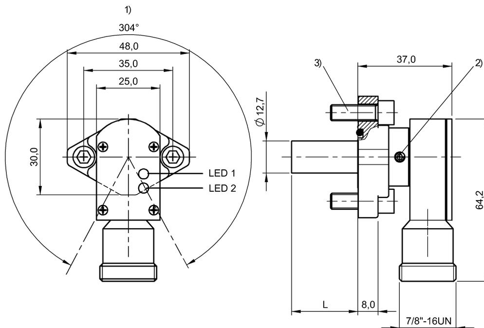
1) Корпус поворачивается на 304°, 2) Момент затяжки 1...1,5 Нм, 3) Момент затяжки 16,5 Нм
