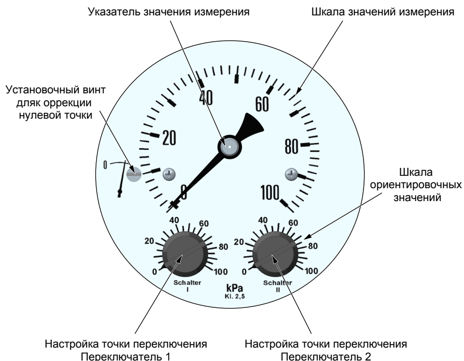
Рис. 10: Элементы управления [DS21]
