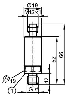
1: Dichtung Prozessanschluss FKM / DIN 3869
