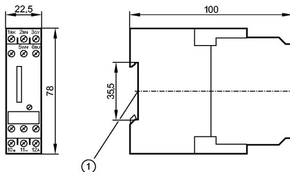
1: Установка на DIN-рейке
