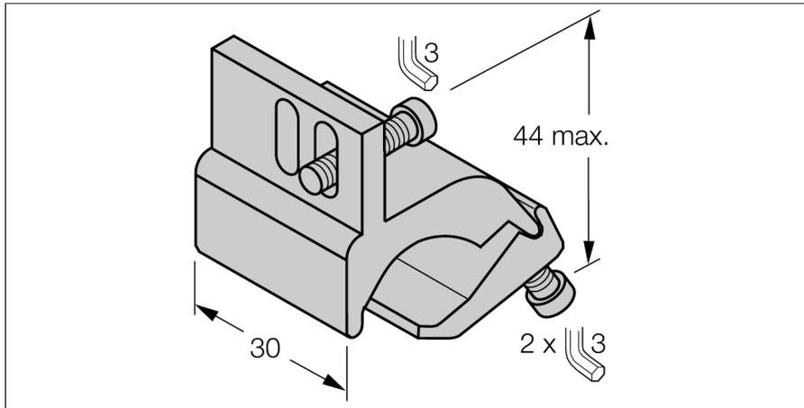
комплектующие для монтажа магнито-индуктивных датчиков на профильные цилиндры диаметром 50...100 мм, алюминий
