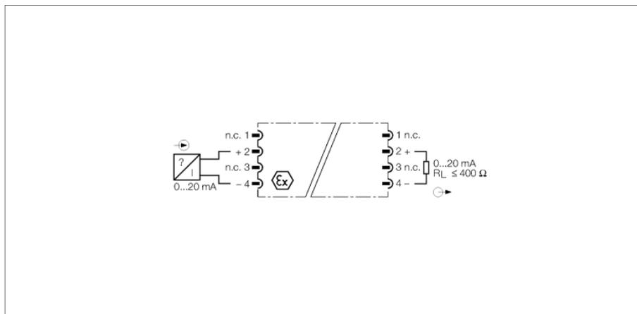
Одноканальный изолирующий преобразователь IMC-AI-11EX-I/L имеет искробезопасную входную цепь. Данное устройство можно устанавливать в зоне 2.
