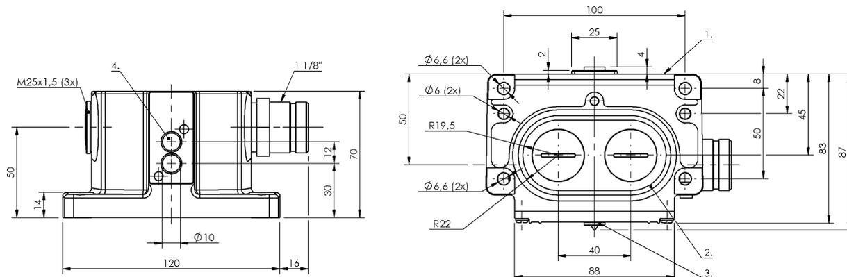
1) Опорная кромка, 2) Уплотнительное кольцо, 3) Функциональный индикатор FD/FE/LL, 4) Активная поверхность
