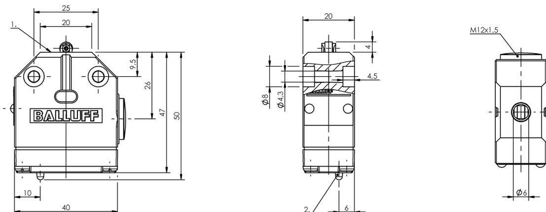
1) Опорная кромка, 2) Функциональный индикатор FC
