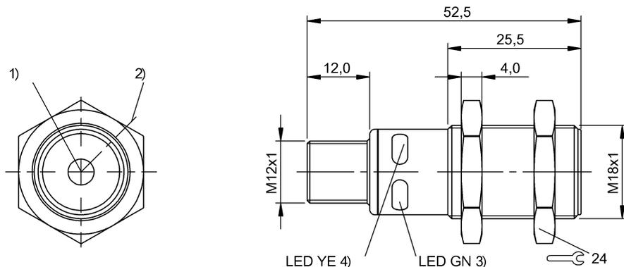
1) Ось ультразвукового преобразователя, 2) Направление отхода 90° штекер, 3) Напряжение питания, 4) Функция выхода
