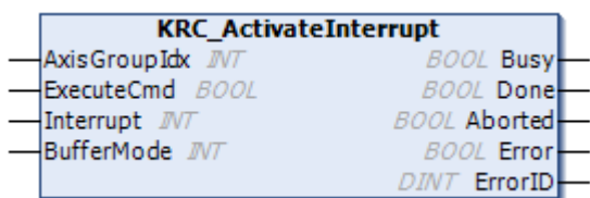
Fig. 17: Function block KRC_ActivateInterrupt
