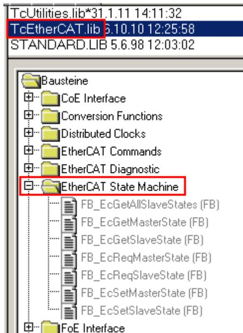
Fig. 90: PLC function blocks
