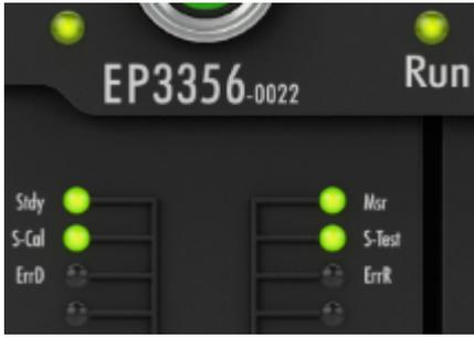
Fig. 39: LEDs EP3356-0022
