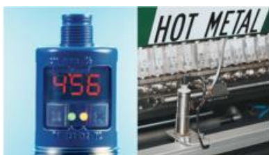
TouchControl с LED дисплеем (л.), Определение диаметра намотки материала в ламинаторе (п.)
